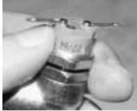
6. Roscar el sensor de corte de salida (punto ROJO) al accesorio de salida (FEP-15DS) o al record de salida (FEP-11DS).
